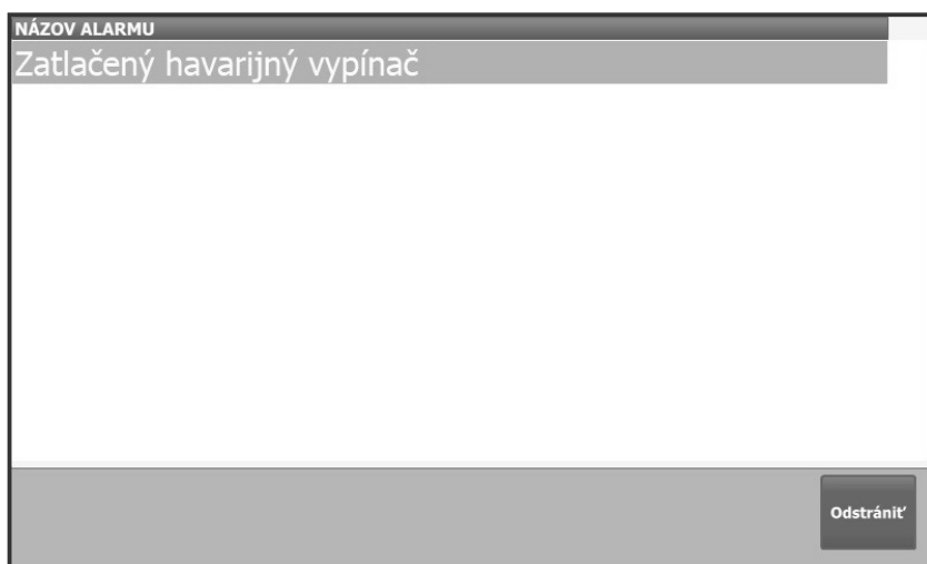
Vzhľad ovládacieho panela snežného dela - obrazovka poruchy
