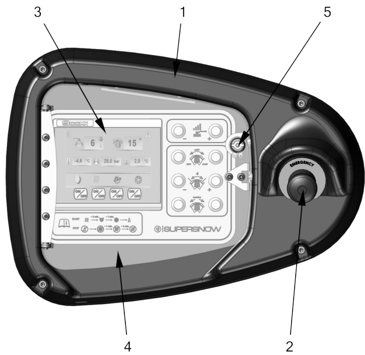
Opis budowy pulpitu sterowniczego armatki śnieżnej 900MN
